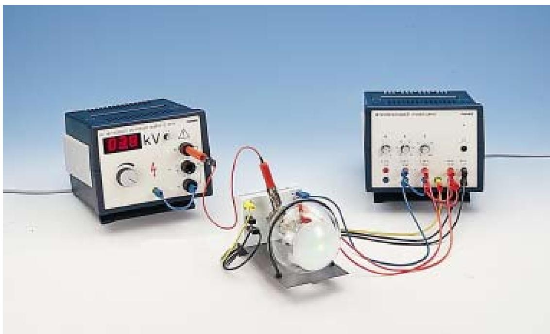
**Fig. 1: Montagem experimental para difração de elétrons.**
